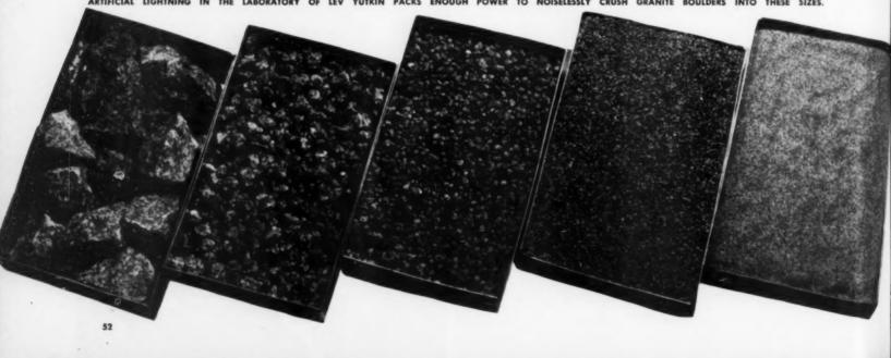
ARTIFICIAL LIGHTNING IN THE LABORATORY OF LEV YUTKIN PACKS ENOUGH POWER TO NOISELESSLY CRUSH GRANITE BOULDERS INTO THESE SIZES.
