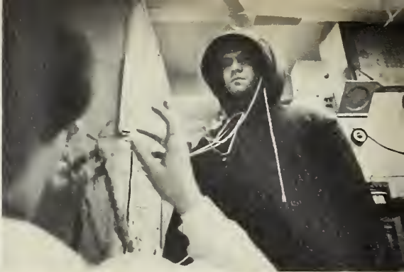
▲ El traje ideado para los exploradores polares es sometido a pruebas en una cámara especial.
