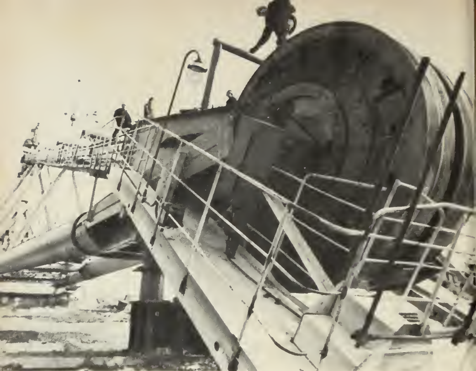
Una moderna excavadora gigante: su brazo tiene 100 m. de largo y su cuchara, un volumen de 100 m 3 .
